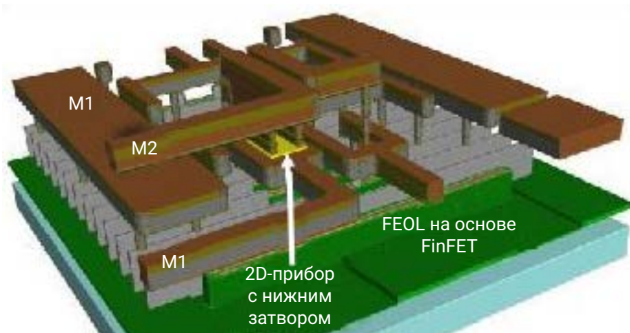
Рисунок 4. 2D-транзистор IMEC с нижним затвором WS_2 -канала, интегрированный в стандартный процесс металлизации
